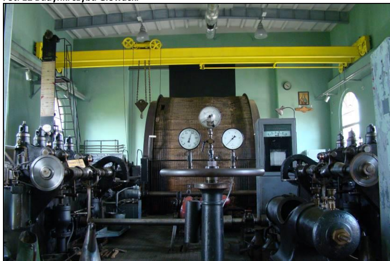
Fot. 13 Zabytkowa maszyna wyciągowa w budynku szybu Głowacki
