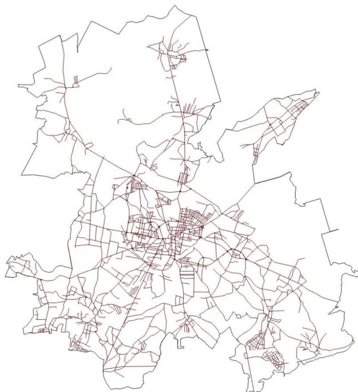
Rysunek 3: Sieć dróg w Rybniku uwzględniona w modelu akustycznym [Źródło: Opracowanie własne]
